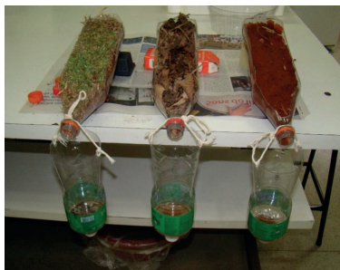
Figura 7 – Representação dos três sistemas: somente solo; solo + folheto e solo+grama.
