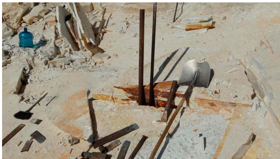
Foto 2 – Ferramentas de trabalho utilizadas pelos trabalhadores no processo de extração de quartzito – Pedreira Meia Lua
