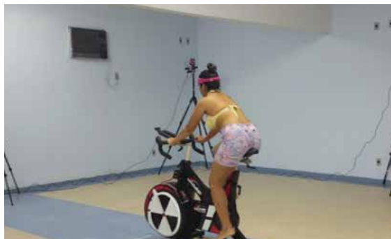
Figura 23 – Laboratório do Movimento ano de 2016, sistemas Nexus e Pollygon e sete câmeras de infra vermelho
