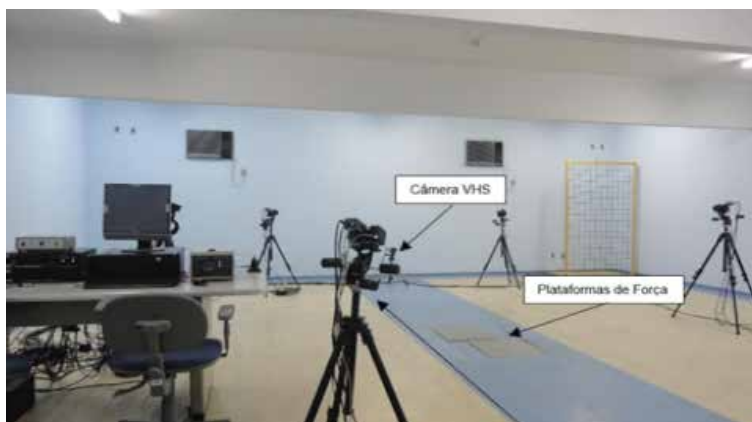
Figura 17 – Laboratório de Movimento da UEG, contendo duas plataformas de força, sistema Vicon Peak e seis câmeras de infravermelho, duas câmeras VHS e um eletromiógrafo
