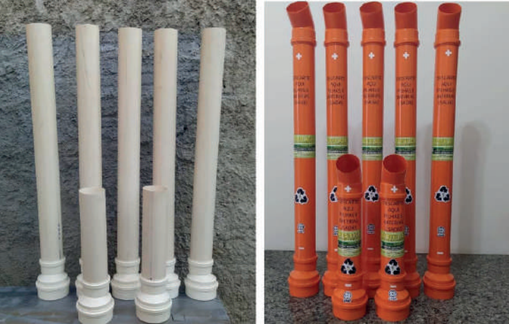
Figura 1 – Personalização dos tubos de PVC para criação de coletores de pilhas e baterias portáteis usadas
