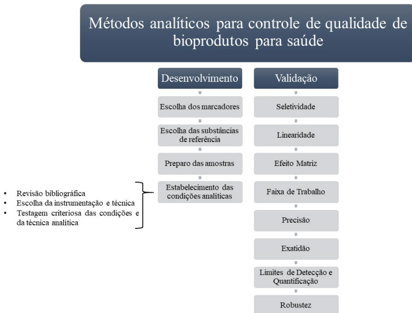
Figura 1 – Esquema das principais etapas do desenvolvimento e validação de métodos analíticos quantitativos para o controle de qualidade de bioprodutos para saúde
